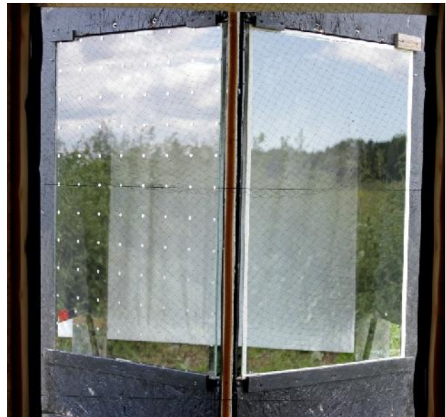
Abbildung 2: Prüfkandidat „SEEN matt“ links, Floatglas Referenzscheibe rechts.
